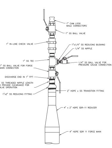
PUMP DISCHARGE MANIFOLD DETAIL
